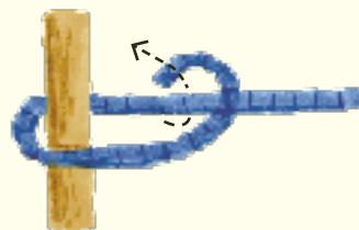
2. Forma un anello facendo passare il corrente sotto il dormiente. Avvolgi il corrente intorno al dormiente.
