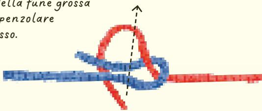
4. Tira il capo corrente sottile sopra il gancio di corda spessa e forma un anello facendolo passare sotto la fune sottile. Il capo corrente della fune sottile ora dovrebbe puntare verso l'alto.
